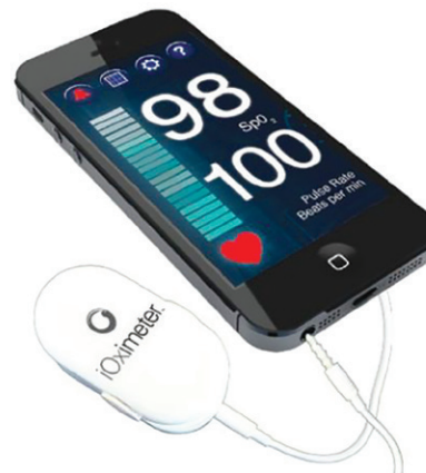
Figure 2 : oxymètre de pouls pour Smartphone (iOximeter®). Il est connecté au smartphone et il permet de mesurer le pouls ainsi que la saturation du sang en oxygène.
